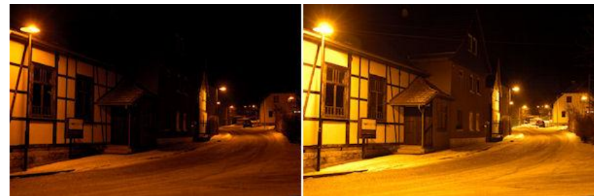
Abbildung 1: gedimmt ( 33% Verbrauch); ungedimmt ( 100% Verbrauch)
